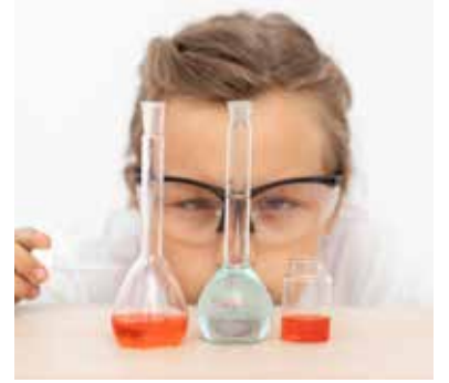
Resim 1.18 Çözelti hazırlama işleminin önemli bir parçası, hacimsel şişeyi işaret çizgisine kadar doldurmak ve sıvı seviyesini göz hizasında gözlemlemektir.
