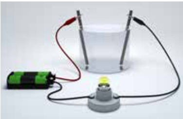
Resim 1.29 Çeşitli maddelerin elektriksel iletkenliğini test etmek için kullanılan cihaz.
