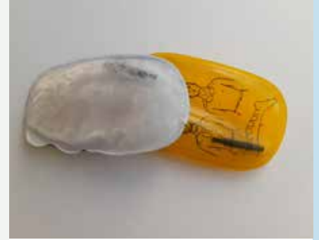
Resim 1.22 Aşırı doymuş çözelti içeren bir el ısıtıcısı.
